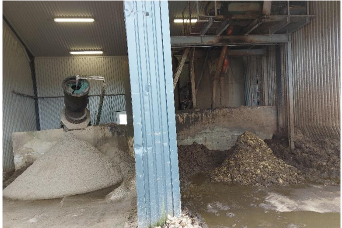
Mynd 5. Sand- og trefjaskiljun úr mykju með vélrænum búnaði.
